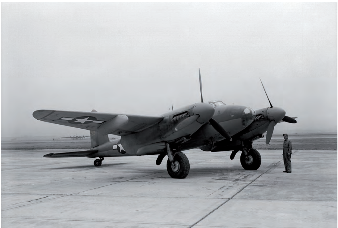
Eine britische De Havilland Mosquito mit amerikanischen Markierungen, eingesetzt als Schnellbomber, Jagdbomber, Markierungs- und Aufklärungsflugzeug. (HF)
