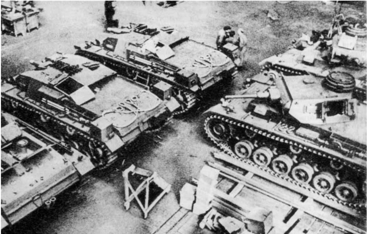
Fertigung von StuG III Ausf B und PzKpfw III Ausf H bei Alkett / Das Fahrzeug ganz links ist ein PzKpfw, der für das Unternehmen »Seelöwe« (Landung in England) mit einer speziellen Auspuffanlage versehen wurde. / Alkett, 6. - 9.1940
