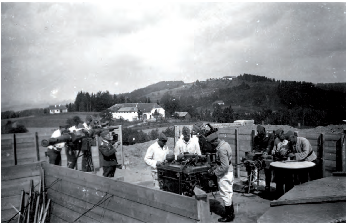
Die Grundausrüstung der Meßstaffel: 4-m-Basis (optisches Distanzmeßgerät), links, Kommando-Hilfsgerät, vorne, und dem „Malsi“-Tisch ganz rechts.
