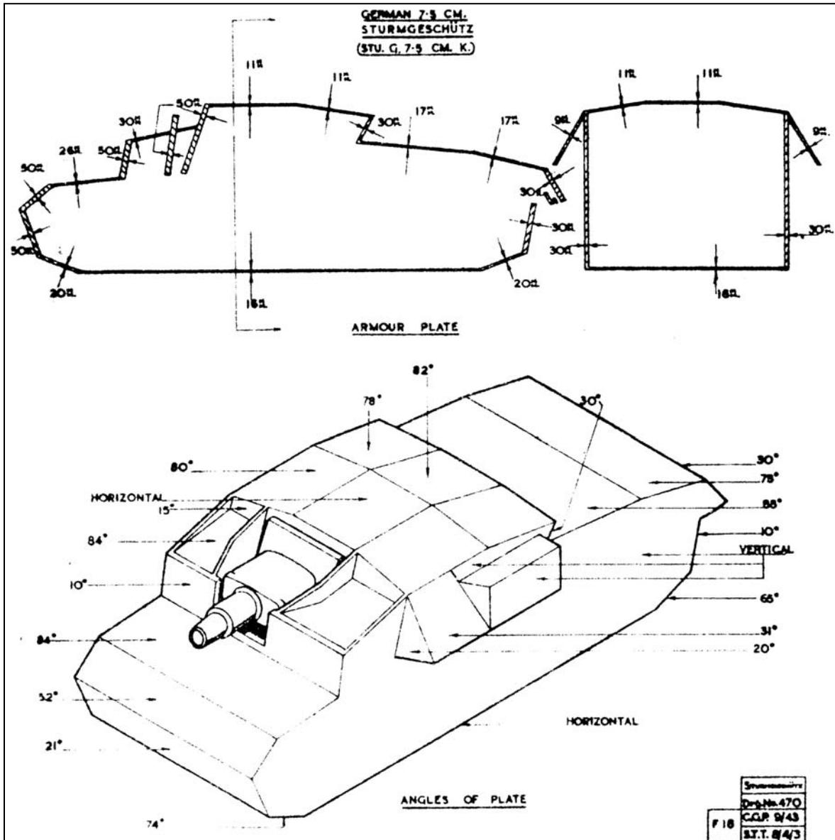
Auslegung der Panzerung der Ausführungen C und D in einem britischen Testbericht / Beachte die geschlossene, stabile Auslegung des vorderen Aufbaubereichs / Alkett, 3. - 10.1941
