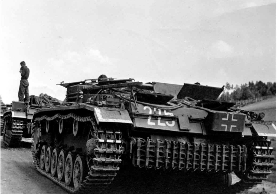
StuG III Ausf D / Die überpanzerne Nebelkerzenabwurfvorrichtung am Heck und das Abstandsfahrlicht auf der linken Kettenabdeckung sind gut zu erkennen / Beachte die neue Antennenlagerung und die Sichtmarkierungen an den Klappen der Kettenabdeckungen/ Die Motor- und Lüfterwartungsklappen sind geöffnet / Alkett, 5. – 10.1941
